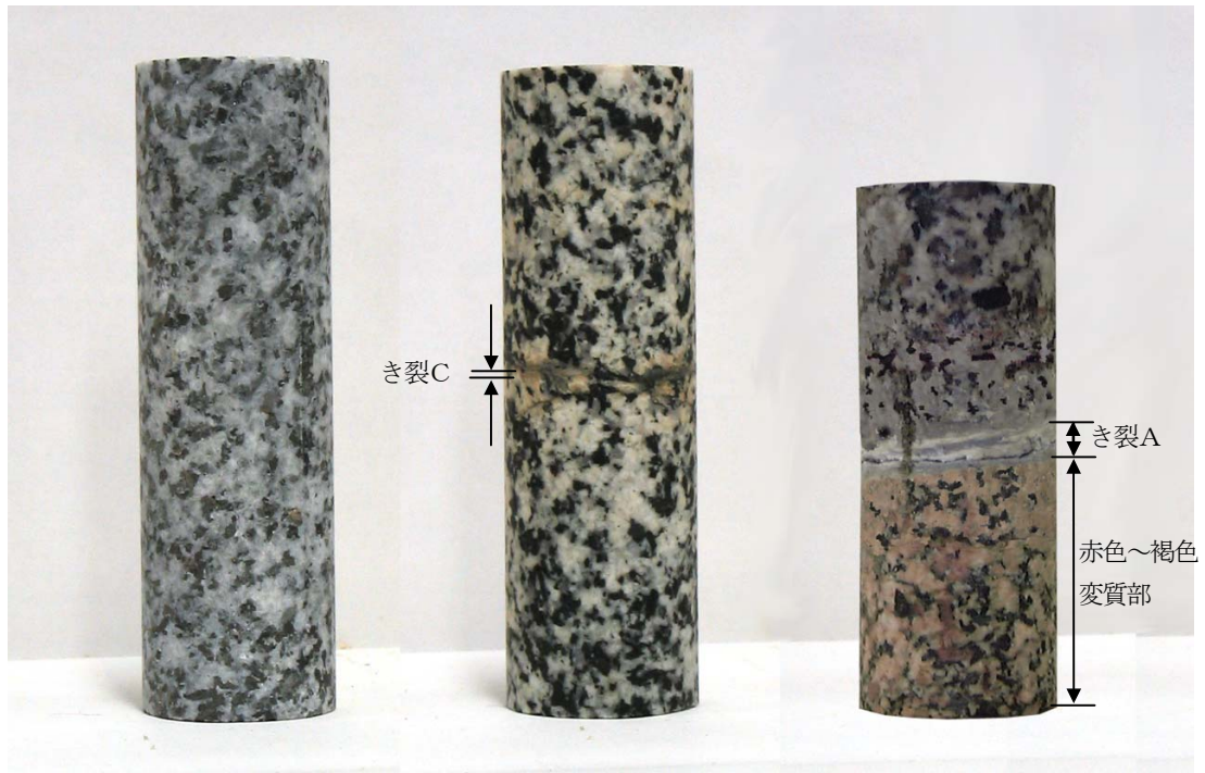
a) き裂を含まない供試体 (KG-2) b) き裂Cを含む供試体 (KG-4) c) き裂Aを含む供試体 (KG-5)
